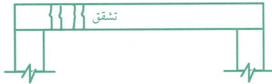
شكل (11 - ب) تشققات طولية عند الأساور
