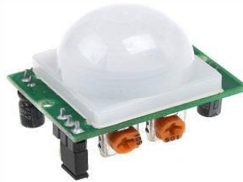
شكل (12) مستشعر الحركة (Passive Infrared sensor)
