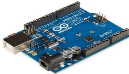
شكل (6) لوحة الأردوينو المستخدمة
