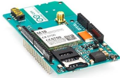
شكل (7) مرسل ومستقبل الجيل الثاني للاتصالات (GSM900)
