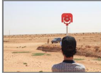
صورة (7): إجراء الرفع المساحي لحدود البحيرة، من قبل الراصد عند الجهاز، وحامل العاكس المُنشوري، تتم القراءة من خلال إرسال أشاره ضوئية من الجهاز إلى العاكس يتم ذلك خلال ثواني، حفرة بوعلي الفرجاني الأربعاء 07.09.2016
